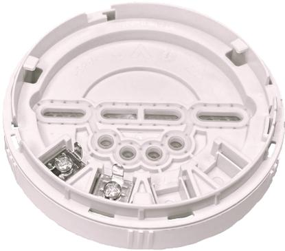
Esta base con 2 contactos es adecuada para entornos húmedos. Simplifica al máximo la instalación, ya que se reducen los errores al haber sólo dos terminales. Los dispositivos de lazo JBE no tienen polaridad, por lo que cada cable del lazo pueden conectarse a cualquiera de los dos terminales disponibles.
